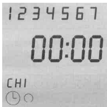
Рис. №1 Состояние дисплея после аннулирования клавишей Reset
